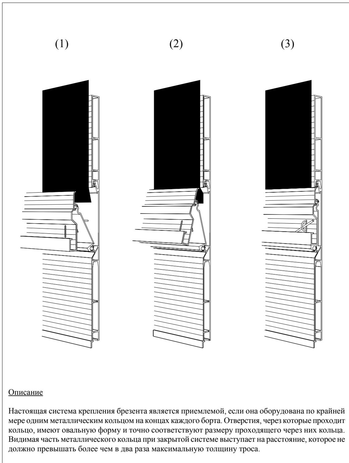
**Рисунок 7****Пример крепления брезента к рамам особой формы**
