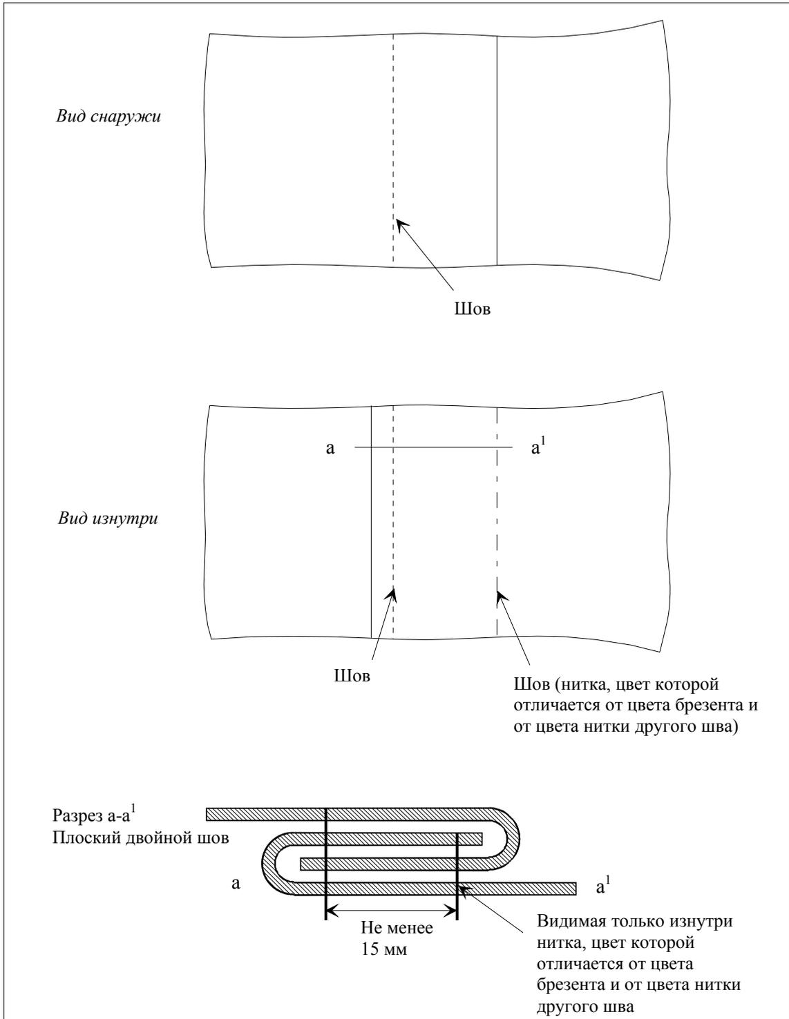
**Рисунок 2****БРЕЗЕНТ, ИЗГОТОВЛЕННЫЙ ИЗ НЕСКОЛЬКИХ КУСКОВ ТКАНИ**
