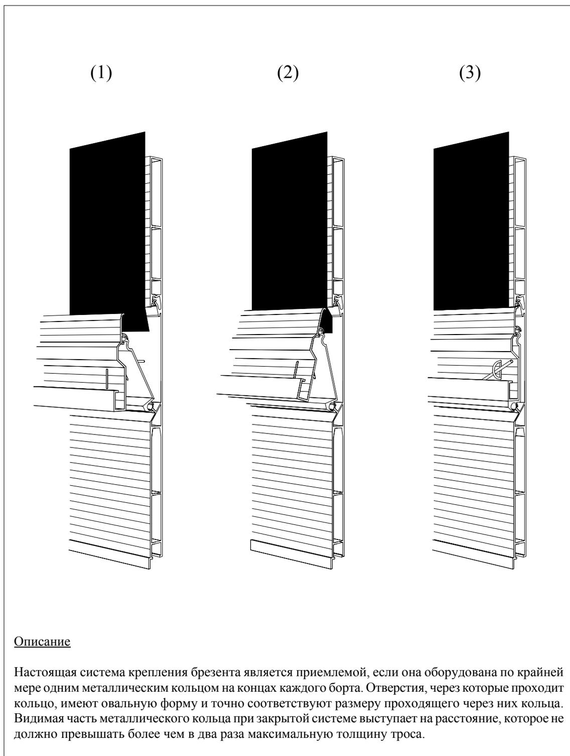
**Рисунок 7****ПРИМЕР КРЕПЛЕНИЯ БРЕЗЕНТА К РАМАМ ОСОБОЙ ФОРМЫ**
