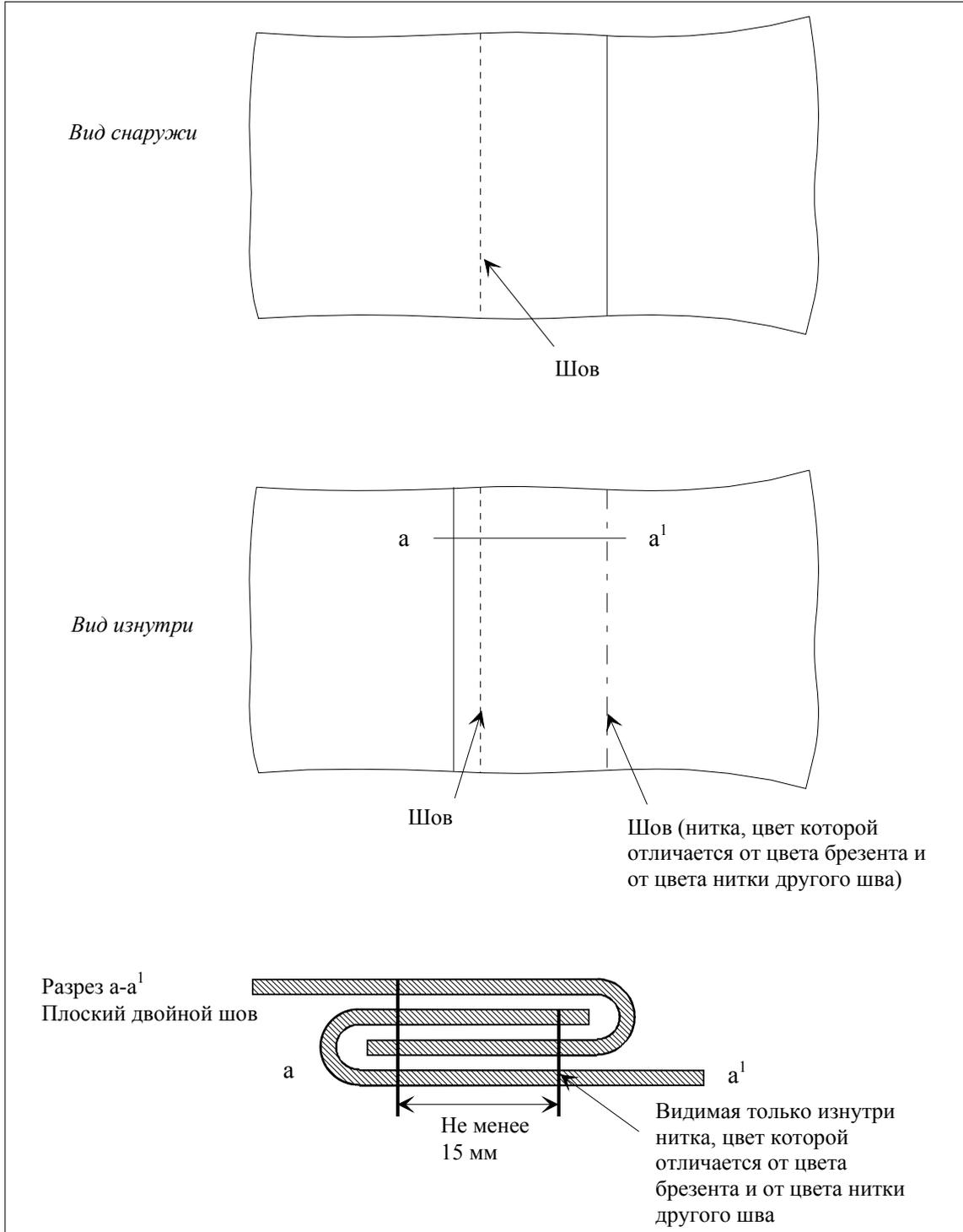
**Рисунок 2****Брезент, изготовленный из нескольких кусков ткани, соединенных при помощи швов**
